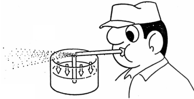
Gambar 5.25 Prinsip Kerja Karburator
