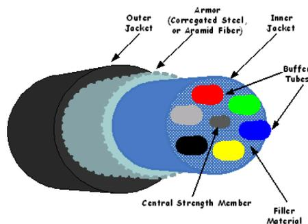
**Gambar 2.46** Kabel *FIBER OPTIC* (Sumber: Dok. Penulis)
