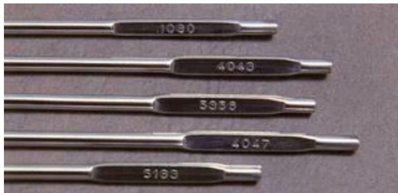
Gambar 8.4 Filler rod untuk mengelas Aluminium dan paduannya
