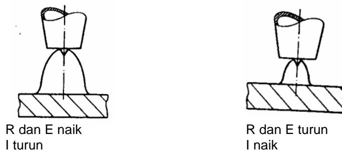
Gambar 2.10 Pengaruh perubahan panjang busur
