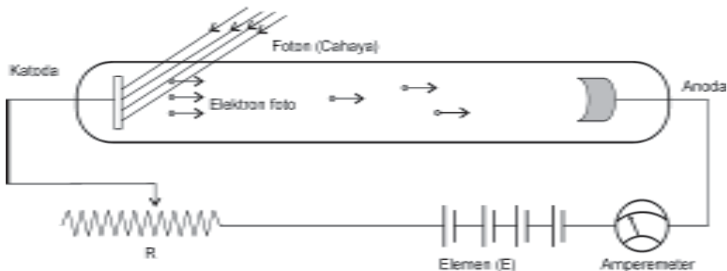
Gambar 7.4 Skema alat untuk menyelidiki efek fotolistrik
