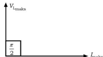
Gambar 6.17 Diagram fasor V dan I pada induktor murni
