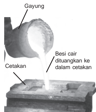
Gambar 2 Lempengan Besi yang akan Dicetak Harus Dipanaskan Terlebih Dahulu sampai Mencair agar Dapat Diolah dengan Mudah. (Sumber: Bridgman, Roger. 1995. Jendela Iptek: Teknologi )
