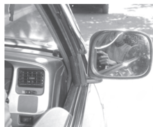
Gambar 9 Kaca Spion pada Motor dan Mobil Menggunakan Cermin Cembung. (Sumber: Haryana, 2006)
