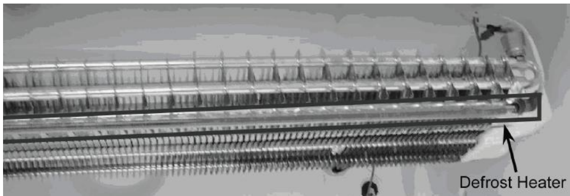
Gambar 2.4 Tipikal Defrost Heater yang terpasang di Evaporator
