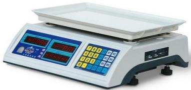
Timbangan Pencampur Cat digunakan untuk menimbang cat, untuk membantu mengkalkulasi rasio pencampuran. Untuk melakukan pengukuran color matching yang akurat, tmbangan dengan tingkatan 0,1 gram sangat diperlukan.
