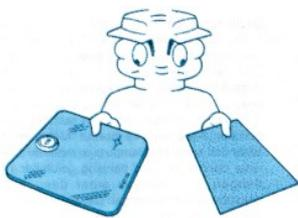
Sangat penting pula, agar contoh untuk perbandingan warna memiliki kilap yang identik dan bebas dari noda. Apabila panel kendaraan kelihatan kurang baik karena perkapuran serta kondisi kerusakan lainnya, maka panel tersebut harus dipoles dengan compound pengkilap, sebelum melakukan perbandingan warna.
