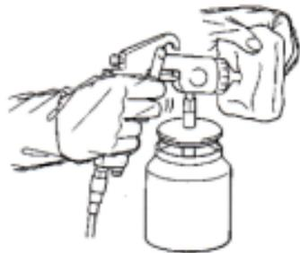
(1). Lepaskan paint cap. Gunakan kain lap di depan air cap dan tarik trigger untuk membilas cat yang tertinggal di dalam saluran
