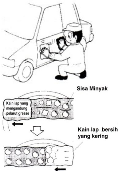
Basahi kain lap yang bersih dengan bahan pelarut grease dan sapukan pada permukaan, untuk melembabi area. Apabila ada sisa minyak yang menempel pada permukaan, hapuslah permukaan dengan kain lap yang kering dan bersih. Jika ada minyak yang menempel pada metal, dapat menyebabkan cat menjadi berbintik-bintik (blister) atau terkupas.
