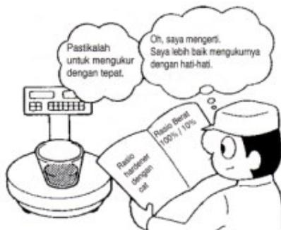
Adalah penting untuk mengikuti petunjuk pabrik pembuat cat agar dapat mengukur hardener dengan tepat, sebelum mencampurnya dengan cat. Apabila step ini tidak diikuti dengan benar, maka berbagai problem dapat timbul, seperti misalnya peeling (terlepas), cracking (retak), staining (belang), atau menimbulkan water spot (bintik air)
