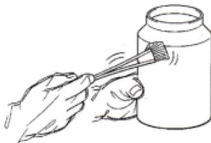
(2). Keluarkan cat yang tertinggal didalam paint cup. Menggunakan sikat bulu, bersihkan bagian luar dan dalam paint cap
