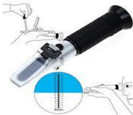
Gambar 30. Pengukuran salinitas perairan dengan refraktometer
