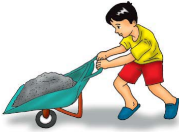
Gambar 7.5 Tuas golongan kedua, misalnya (a) gerobak roda satu, (b) alat pemotong kertas, (c) alat pemecah kemiri
