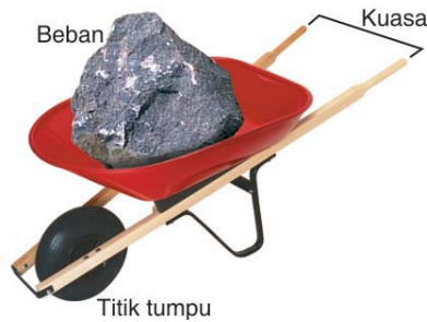
Gambar 7.6 Letak titik tumpu, beban, dan kuasa pada gerobak roda satu
