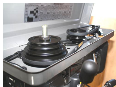
Gambar 6.6 Transmisi bor 12 tingkat kecepatan
