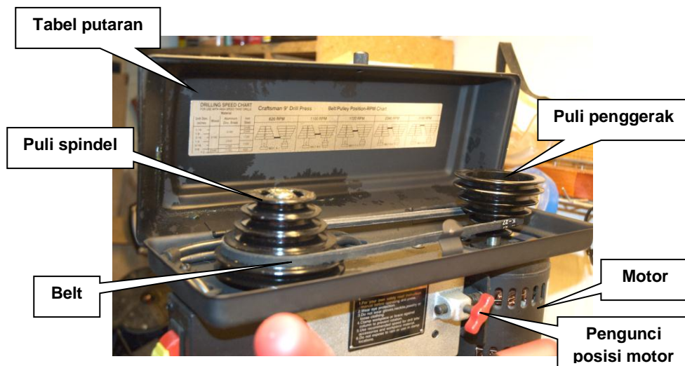
Gambar 6.5 Transmisi bor lima tingkat
