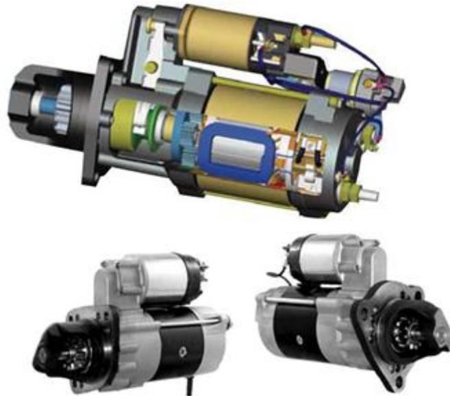
Planetary dan poros pembawa (Unit gigi planetary terdiri dari beberapa komponen, yaitu ring gear, gigi planetary, pembawa gigi plarrier shaft). Armature menghasilkan putaran yang tinggi. Putaran ini sebagai input pada sistem gigi planetary. Output dari sistem roda gigi planetary adalah putaran yang lebih lambat dibandingkan dengan putaran armature tetapi dengan torsi yang lebih tinggi.
