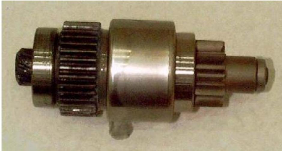
Overrunning clutch drive (Gambar 78) adalah jenis penggerak clutch paling sederhana yang dipergunakan pada motor starter heavy duty. Overrunning clutch drive membutuhkan sebuah tuas untuk menggerakkan pinion berupa kasa dengan flywheel ring gear. Pinion tersebut diaktifkan dengan flywheel ring gear sebelum armature mulai berputar.
