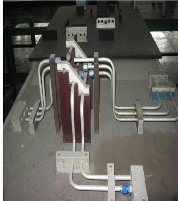
Gbr. 4. 11 : Hasil pembengkokan pipa alumunium
