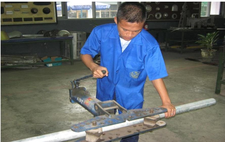
Gbr. 4. 12 : Proses pembengkokan pipa secara hidrolik
