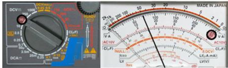
Gambar mengukur tegangan DC (DCV) pada rangkaian
