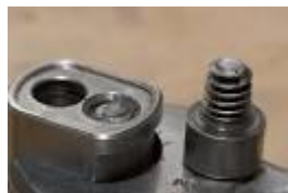
Gambar Kepala baut patah
