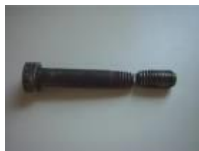
Gambar baut tertarik dan patah
