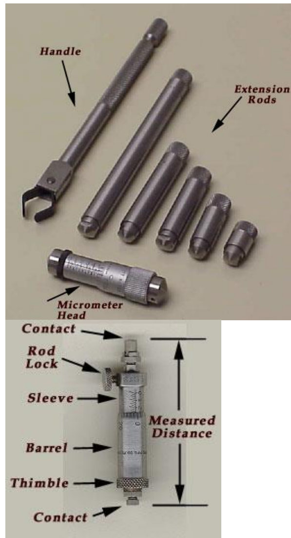
Gambar Mikrometer Dalam untuk pengukuran 5 – 30 mm
