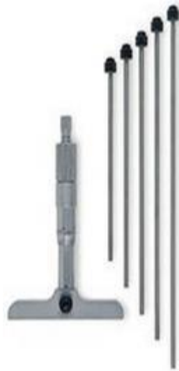
Gambar Mikrometer Kedalaman dengan batang berbagai rentang ukur
