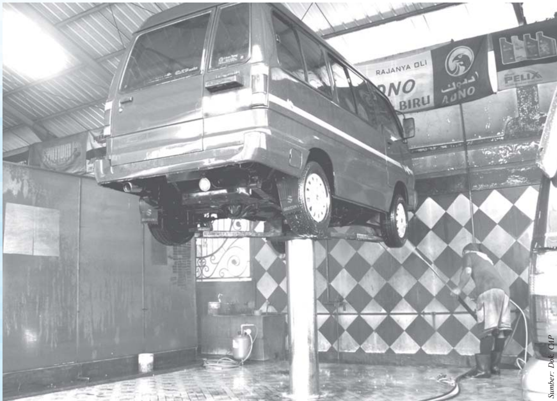
Gambar 7.1 Pemanfaatan sistem hidrolis pada alat pengangkat mobil
