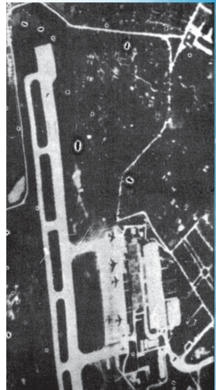
Gambar 3.16 Citra inframerah termal Bandar Udara Halim Perdana Kusuma tampak terminal, halaman parkir pesawat, landasan pesawat, dan jalan tampak cerah karena lebih panas dari sekitarnya.
